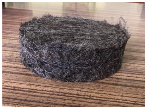
Fig. 2 Material format prin presare la cald din lâna.
