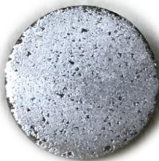
Fig. 1. Probă sinterizată (Fe-grafit-nichel carbonil) presat la 600 MPa
